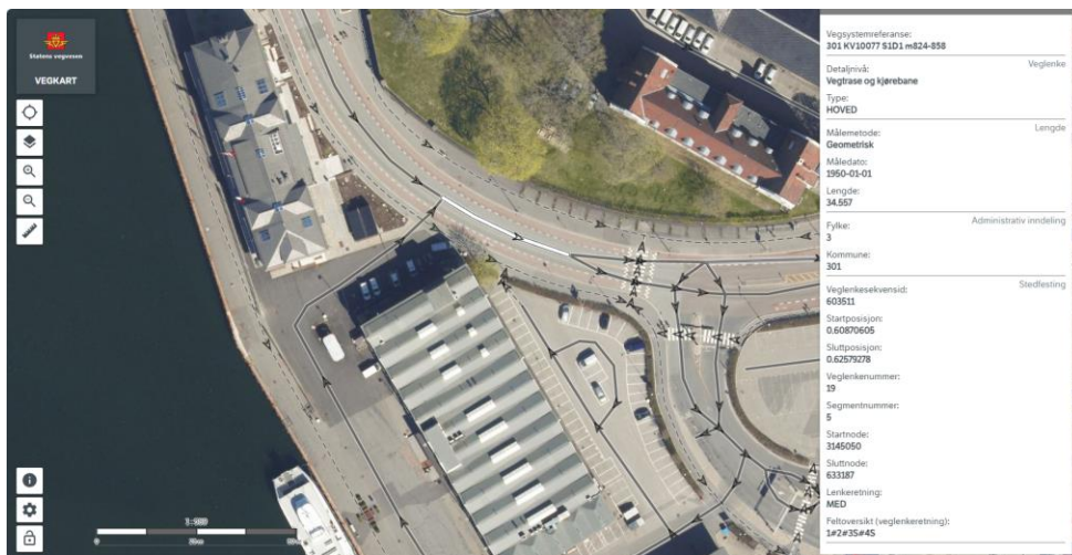
Figur 2: Der sykkelfelt er en del av kjørebane ligger det i dag informasjon på veglenken om at det også ligger sykkelfelt i kjørebane. I dette eksempelet har vi et felt i hver retning for vanlig trafikk (1#2), og så er det i tillegg sykkelfelt på hver side av disse (3S#4S). Foto: Vegkart
